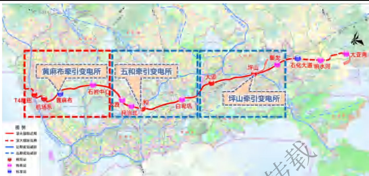
图 2.4-3 牵引变电所供电范围
