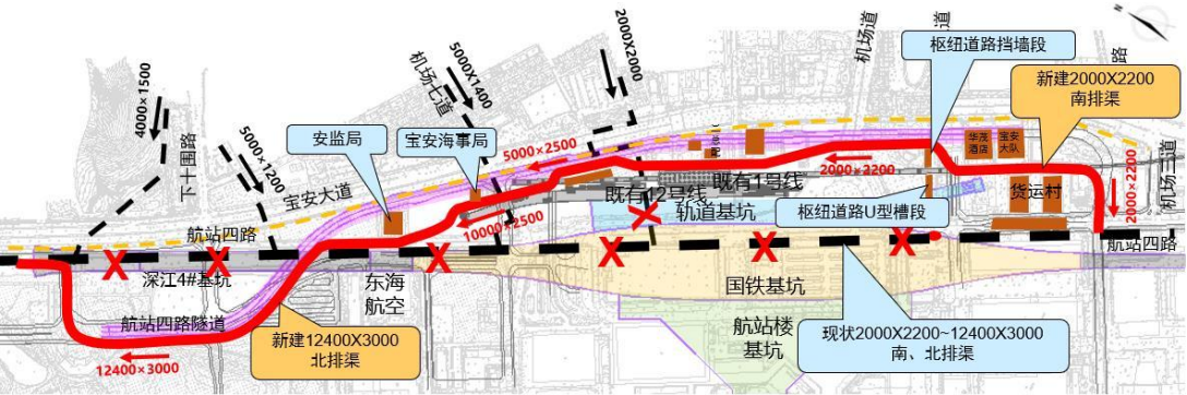
图 4-2 机场南、北排水渠现状及迁改工程
